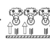
L'impact de ces bulles fractionne la saleté et sépare les impuretés à la surface de l'article. La saleté est ainsi séparée dans l'eau.
