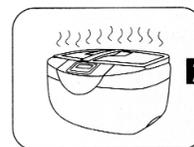
Si vous utilisez le nettoyeur avec chauffage durant plus de 3 cycles, le circuit de protection interne peut interdire une nouvelle utilisation. Dans ce cas, attendre environ 15 minutes avant de recommencer un nouveau cycle de nettoyage.
