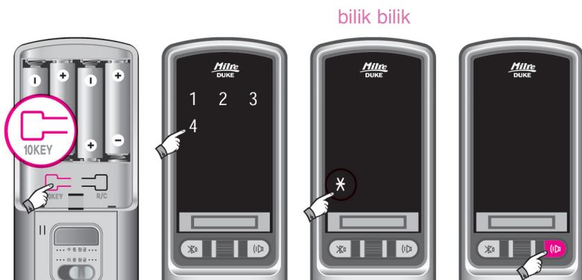
Ouvrez le capot des piles et pressez brièvement le bouton [10KEY]
