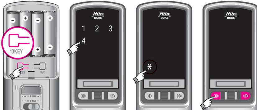
Ouvrez la capot des piles et pressez brièvement le bouton [10KEY]
